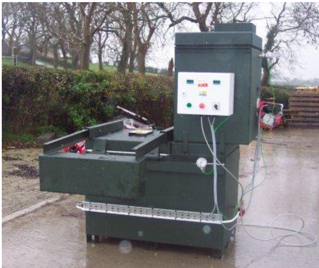
Piec do spalania martwych zwierząt typu MB240F. (źr. strona internetowa dystrybutora – firmy Vitec Agro).
